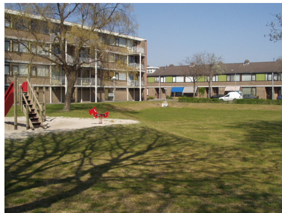
figuur V verlaagde speelvelden in Straakven. Bij hevige neerslag loost het regenwaterriool op deze velden en infiltreert in de bodem
